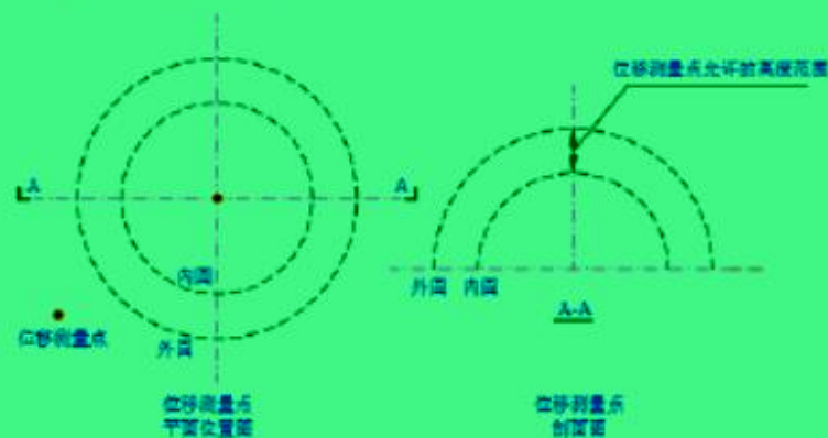
图 9 位移测量点位置示意图
